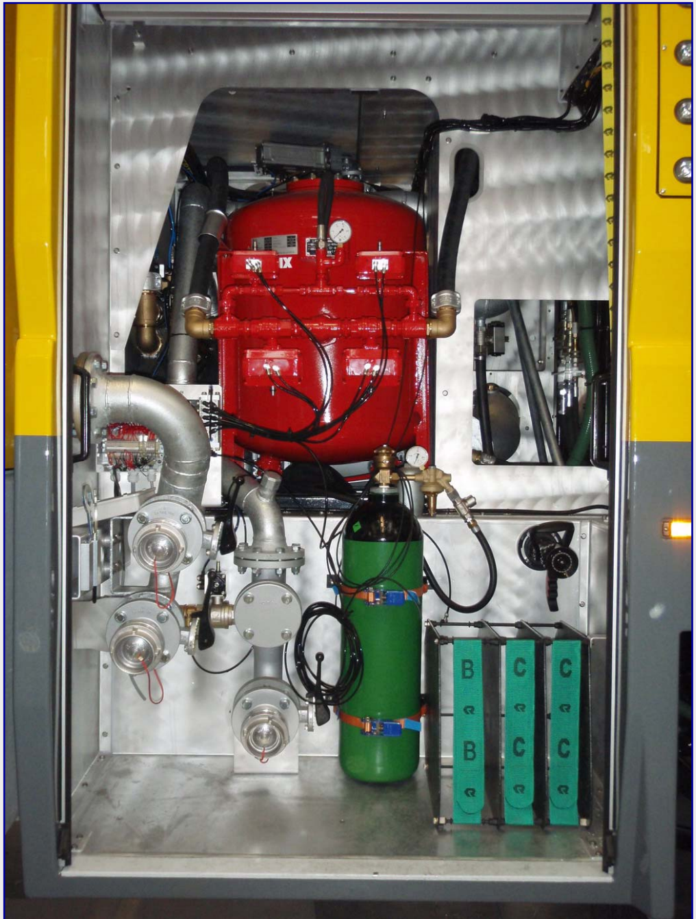
Hydro-Chem pulveranlæg 225 kg. med nitrogen som drivmiddel
